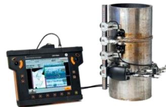
Contrôle non destructif et essai mécanique des soudures
